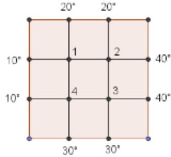
We zoeken  $T_1, T_2, T_3$  en  $T_4$ , de temperaturen in de 4 inwendige knopen. We weten dat de temperatuur in een knooppunt bij benadering gelijk is aan het gemiddelde van de temperaturen in de nabijgelegen knooppunten. Zo is voor de figuur hiernaast bijvoorbeeld  $T_1 = \frac{10 + 20 + T_2 + T_4}{4}$ .
